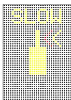
在整个停靠过程中, 如果航空器滑行速度超过4米/秒(7.7海里/小时), 系统会显示' SLOW DOWN ', 以防止航空器超越停机线。
