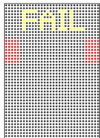
航空器必须在距停止线12米(供1-29号机位)/18米(供50-98号机位)前被系统识别, 否则, 系统将先显示' STOP ', 然后显示' ID FAIL '。
