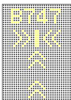
显示正确的航空器型号, 滚动箭头表明系统处于工作状态。
