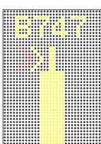
当系统显示一条垂直黄色接近速率光带时, 表明系统的扫描装置已捕捉到航空器。此时, 扫描装置正检测航空器的几何特征并显示方位引导信息, 以保证停靠安全。闪烁的红色箭头和稳定的黄色箭头提供方位引导, 闪烁的红色箭头方向表示应该修正偏差的方向。
